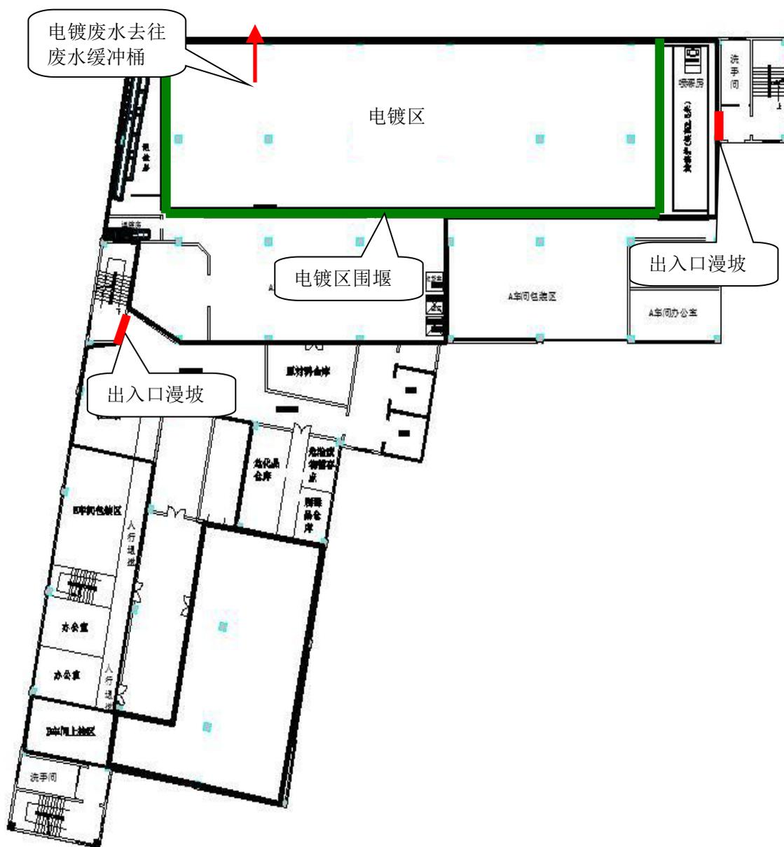
注：事故时，利用围堰和漫坡收集车间产生的消防废水，电镀区废水通过管网进入废水缓冲桶，再送至基地废水处理站处理。
